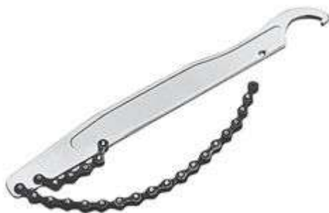
Bičik na pastorky /Na pridržanie pastorkov pri povoľovaní poistnej matice./ TL-SR20
